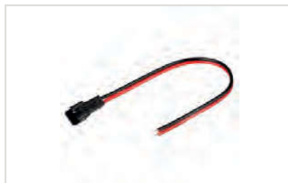
Артикул 022353 Разъем MAMA (система "клик") для соединения отрезков одноцветных светодиодных лент. Корпус черный. Провод 20AWG, длина 15 см. Максимальный допустимый ток 3А.
