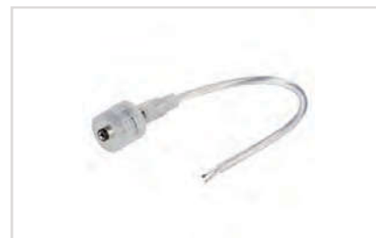
Артикул 022315 Круглый герметичный разъем DC 2-pin ПАПА для соединения отрезков одноцветных светодиодных лент. Корпус IP65. Провод 20AWG 15 см. Максимальный допустимый ток 3А.
