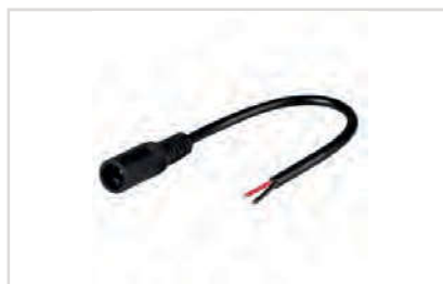
Артикул 022356 Круглый разъем DC 2-pin MAMA для соединения отрезков одноцветных светодиодных лент. Провод 20AWG, длина 150 мм, размер гнезда 2.1 5.5. Максимальный ток 3А. Цена за 1шт.
